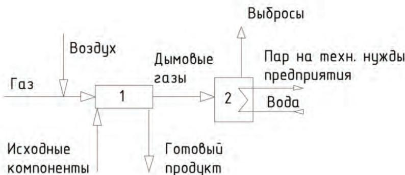
Рис. 1. Схема утилизации тепловой энергии газов.
