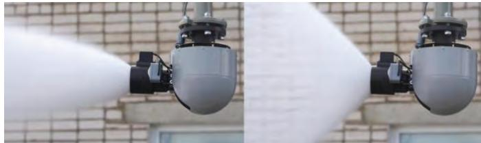
Рис. 1. Пожарный мини - робот с расходом 10 л / с.
