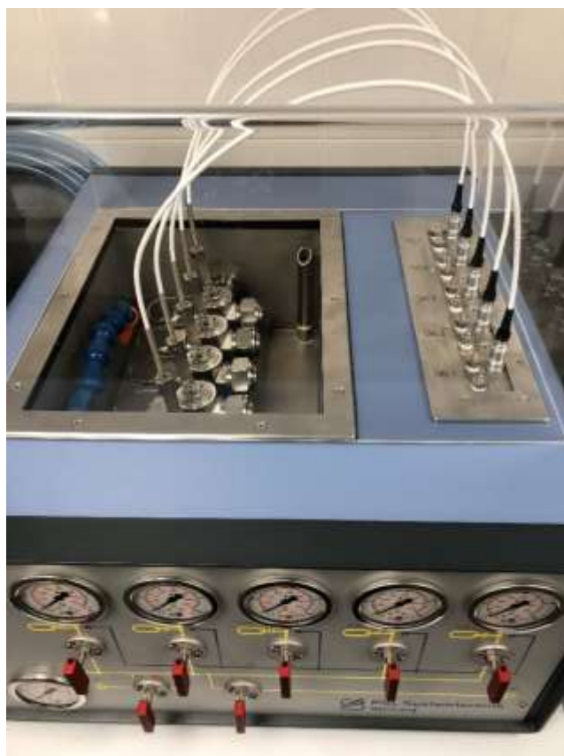
Рис. 2. Фотография установки с качающимися ячейками RC5 (Rocking Cells; PSL Systemtechnik GmbH, Германия)
