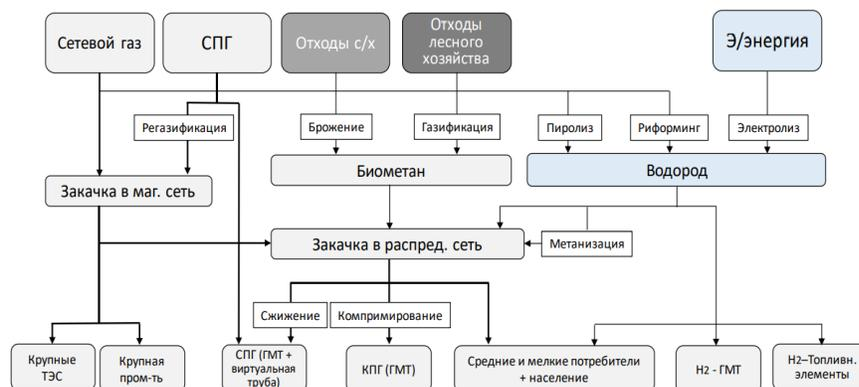
Рисунок 2 – Возобновляемый газ и технологии его производства: интеграция в традиционную газовую производственную цепочку
