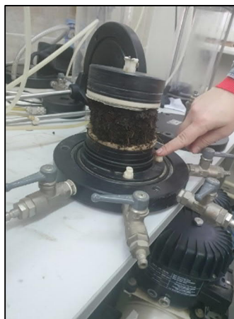
Рис. 8. Грунт между распределительной крышкой и пьедесталом прибора
