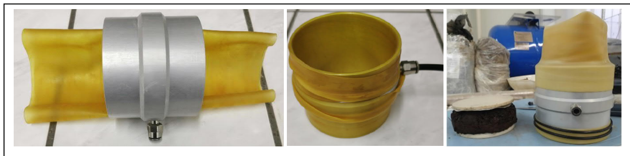
Рис. 9. Операция подготовки латексной оболочки к размещению на образце
