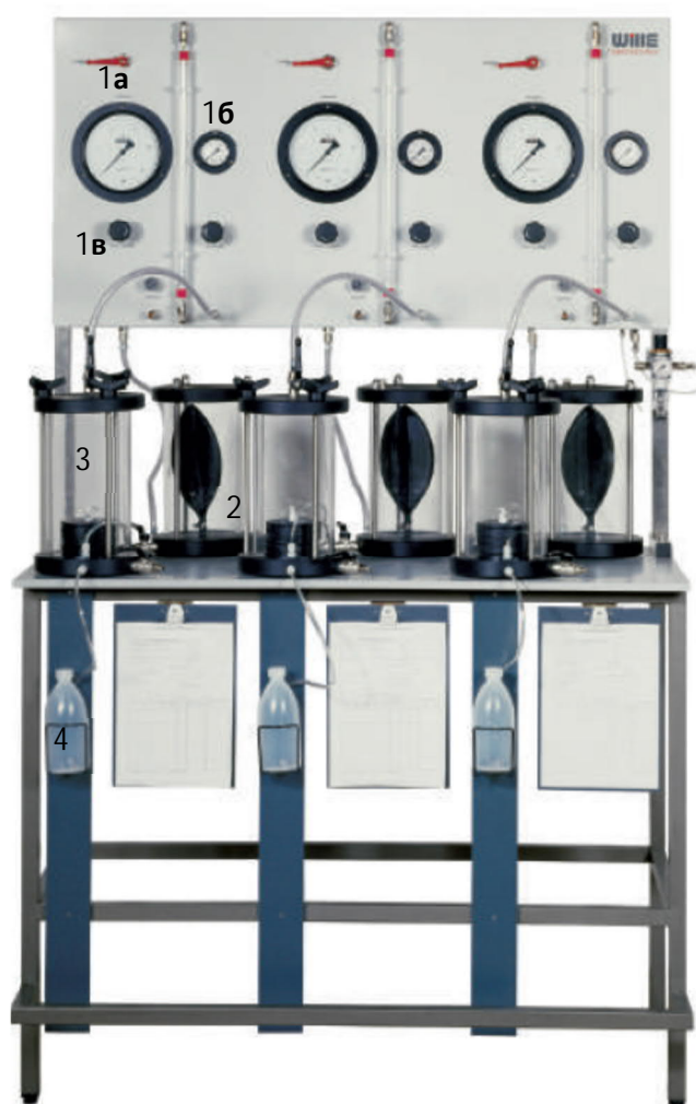
Рис. 7. Общий вид фильтрационного прибора D 3325S конструкции Wille Geotechnik (Германия)
