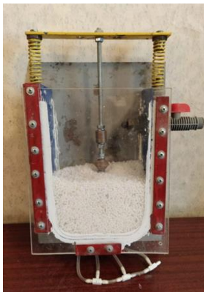
Рис. 3. Физическая модель для исследования вибрационного гидроструйного метода обработки
