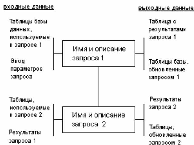
Рис. 7.23. Функционально-технологическая схема задачи из двух последовательно выполняемых запросов
