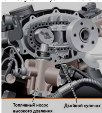
Рис. 7.27. Привод одноцилиндрового топливного насоса высокого давления
