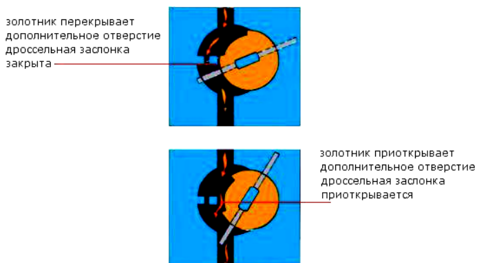
Рис. 7.53. Схема работы золотника
