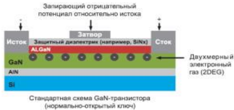
Рисунок 1 - Структура GaN-транзистора
