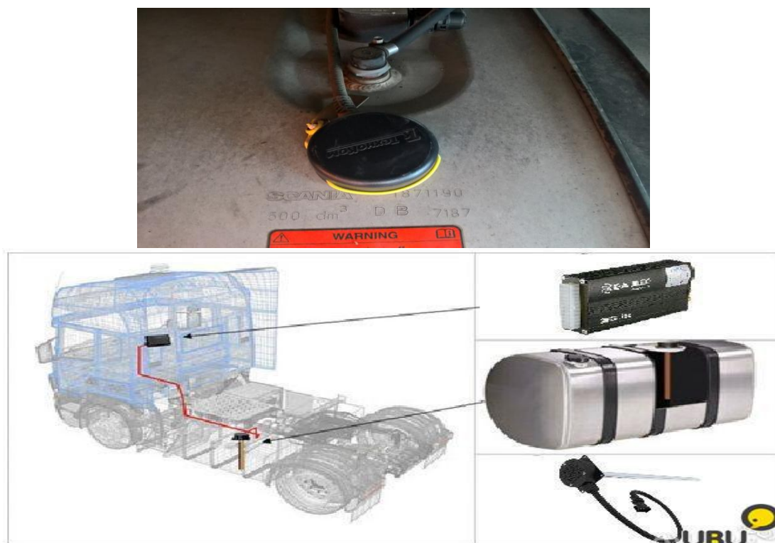
Рис. 2. Датчик блокировки двигателей при несанкционированных попытках движения – угоне
