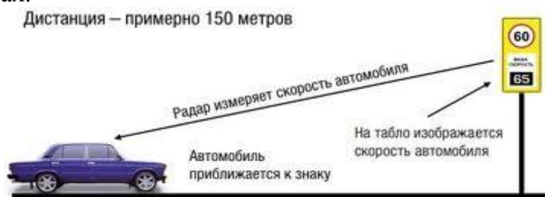
Рис. 3. Знак переменной информации с обратной связью с водителем
