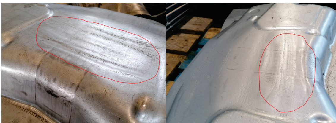
Рис. 1. Выявленные дефекты в виде морщинистости на поверхности изделия
