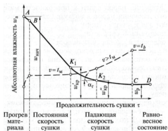
Рис. 2. Кривая скорости сушки материала и изменение его температуры в процессе сушки
