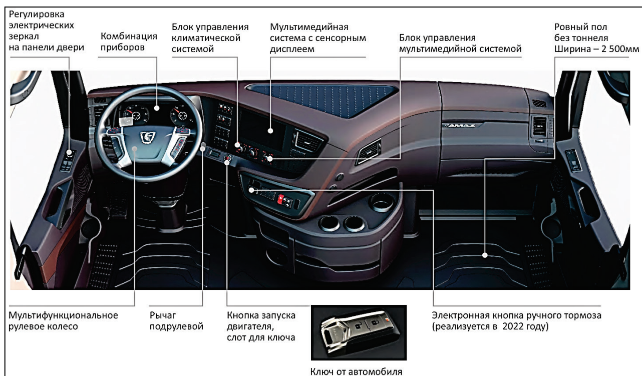
Рис. 1. Устройство кабины КАМАЗ 54901 (поколение K5)
