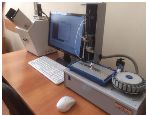
Рис. 1. Состав денситометра Sorbfil.
