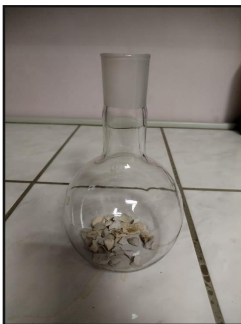
Рис. 2. Кипелки – осколки фарфора для обеспечения равномерного кипения.
