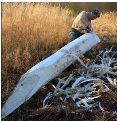
Рис. Выравнивание днища обласа. Стойбище Энел Ури, Нижнеартовский район, 2013 г., фото А.С. Айпина.
