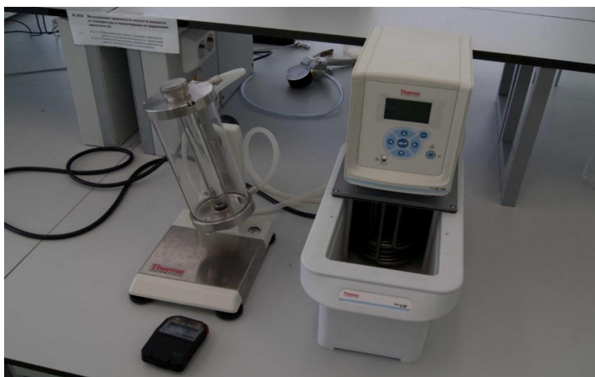
Рис.1. Лабораторная установка 1)Шариковый вискозиметр; 2)Нагреватель
