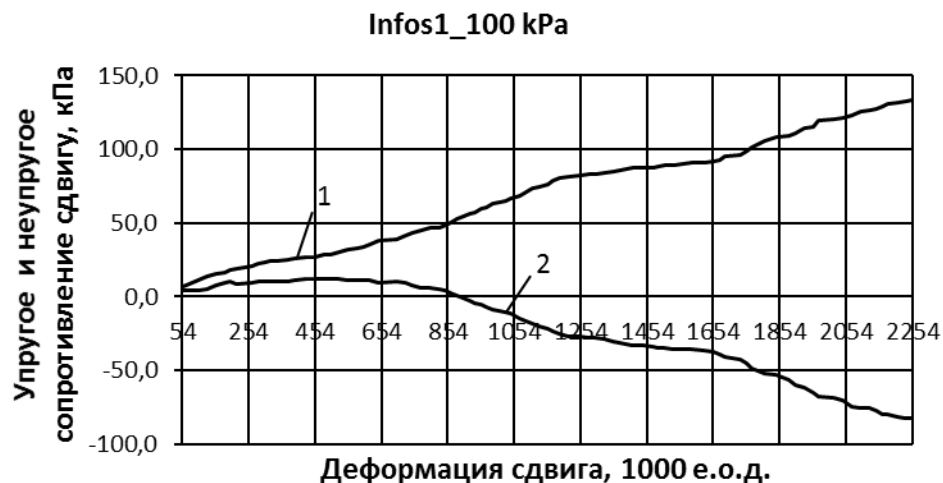
Рисунок – Графики сумм упругих (1) и неупругих (2) частей сопротивления образца сдвигу по [2]
