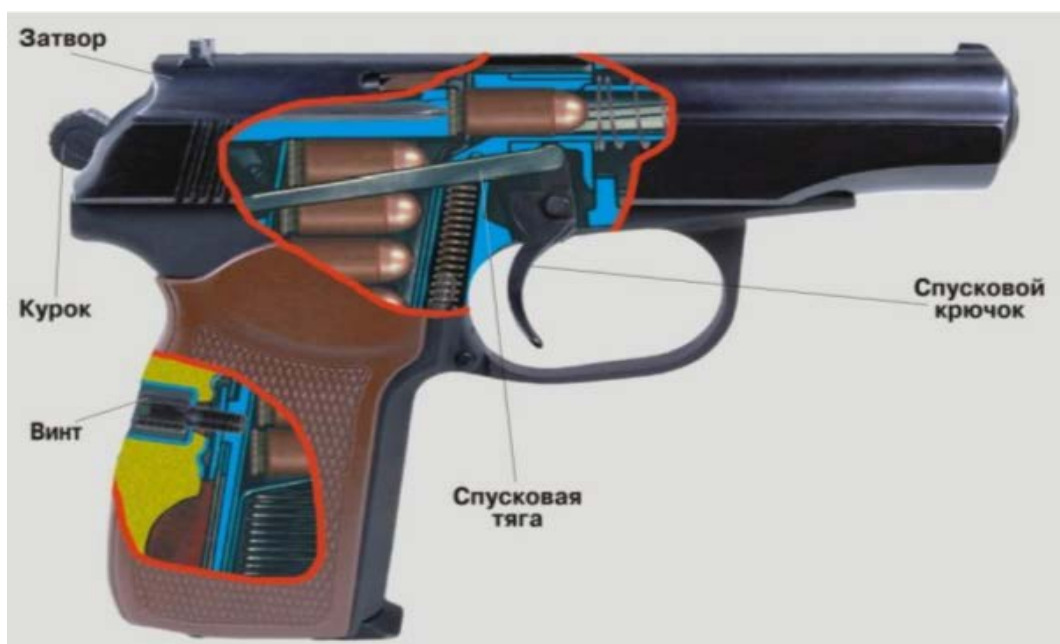
Рис. 9. Положение частей и механизмов перед выстрелом в момент спуска курка с боевого взвода пистолета ПМ
