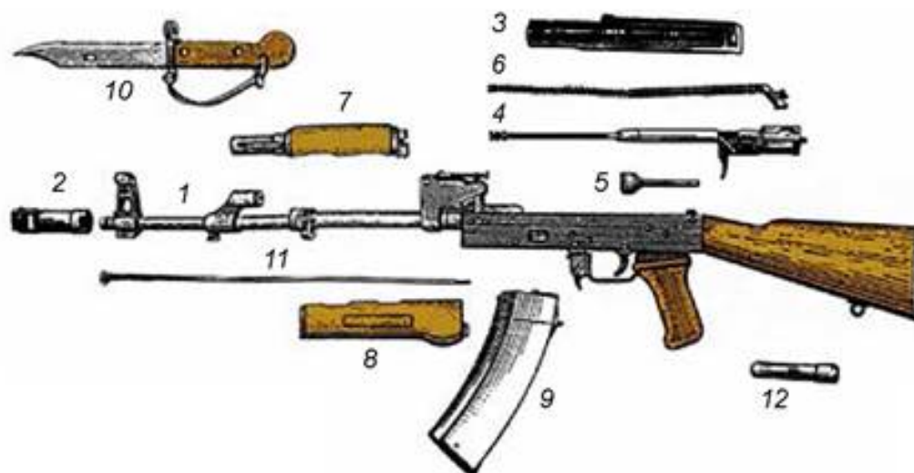
Рис. 2. Основные части и механизмы автомата и его принадлежности: 1 – ствол со ствольной коробкой, с ударно-спусковым механизмом, прицельным приспособлением, прикладом и pistolетной рукояткой; 2 – дульный тормоз-компенсатор; 3 – крышка ствольной коробки; 4 – затворная рама с газовым поршнем; 5 – затвор; 6 – возвратный
