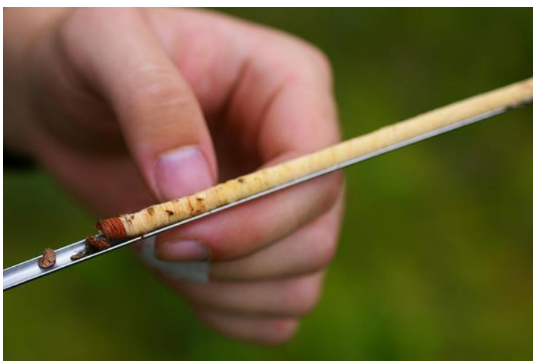
Рисунок 2. Отбор кернов возрастным буром Пресслера
