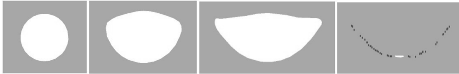
Рис. 5 – Основные стадии заживления исходной симметричной поры (верхняя центральная пора показанная на рис. 2) под действием сжимающей силы, инициированной лазерным импульсом/плазмой. Пора находится в поверхностном слое неравномерно нагретого материала (рис. 2–4)
