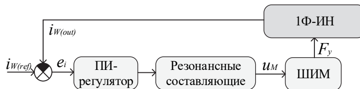
Рис. 7 – Структурная схема системы управления возбудителя в стартерном режиме работы
