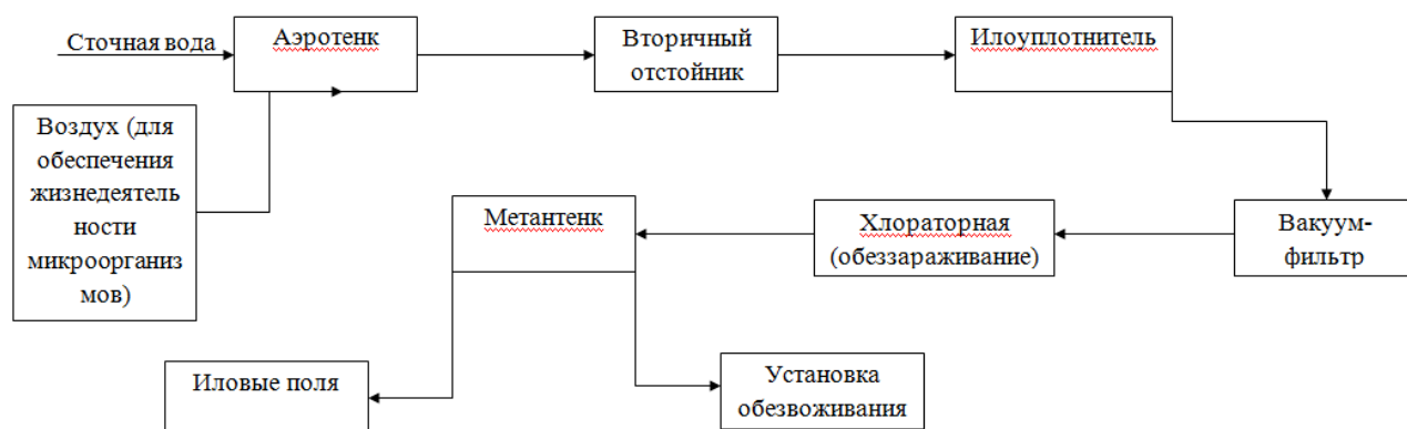
Схема локального очистного сооружения
