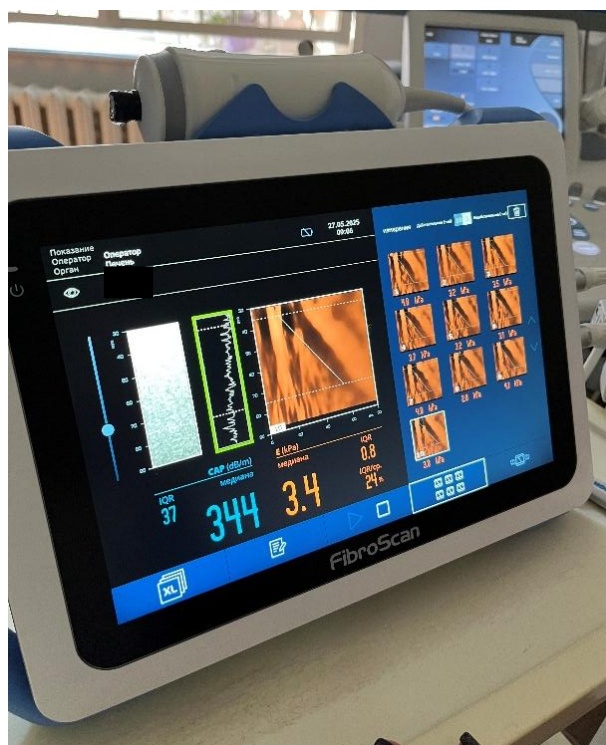
Рисунок 6. Транзиентная эластография с Fibroscan™. При формировании отчета на экране отображается эхо-сигнал М-скана, амплитуда однолинейного А-скана, смещение М-режима после контролируемого вибрацией импульсного толчка на поверхность.
