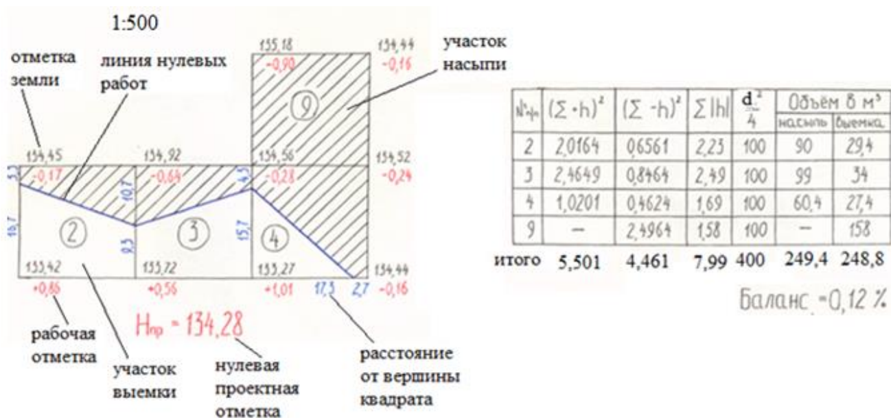
Рис. 29. Картограмма земляных масс в масштабе 1:500
