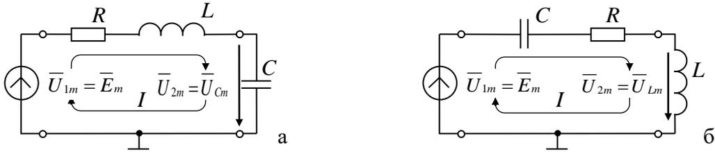
Рис. 1.5. Последовательный колебательный контур как четырехполюсник с емкостным выходом  $U_C$  (а) и индуктивным выходом  $U_L$  (б)
