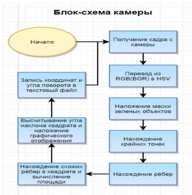
Рисунок 10, 11 – Блок-схема основного робота и блок-схема камеры
