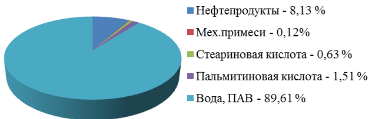
Рис. 2. Компонентный состав свежей СОЖ «Исанол ВПС-2»
