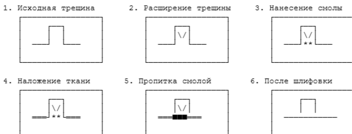
Рис. 13. Последовательность ремонта трещины в композитной раме
