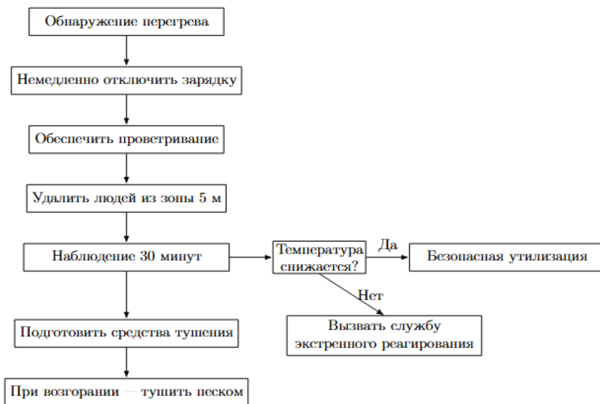
Рис. 52 Алгоритм действий при перегреве АКБ
