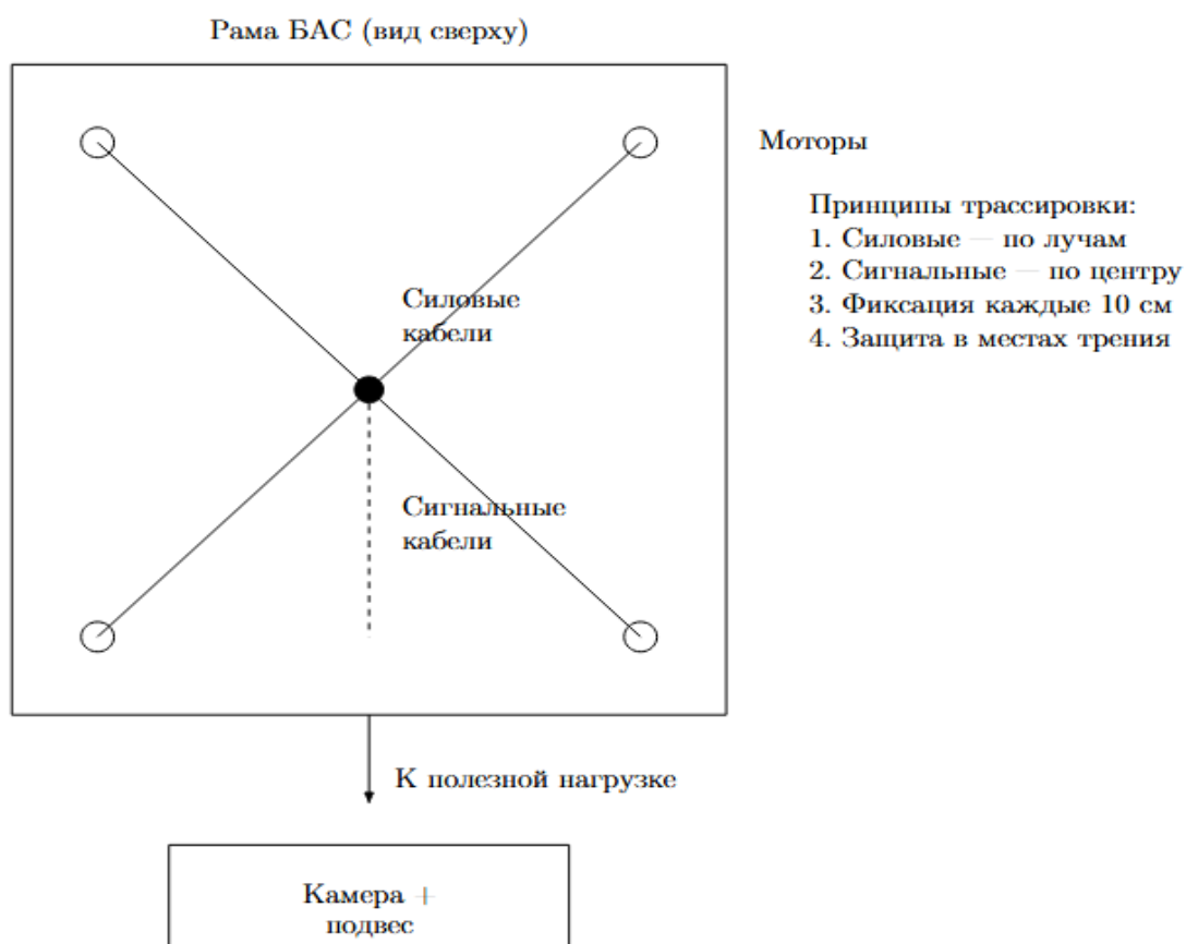
Рис. 67. Правильная трассировка кабелей на БАС
