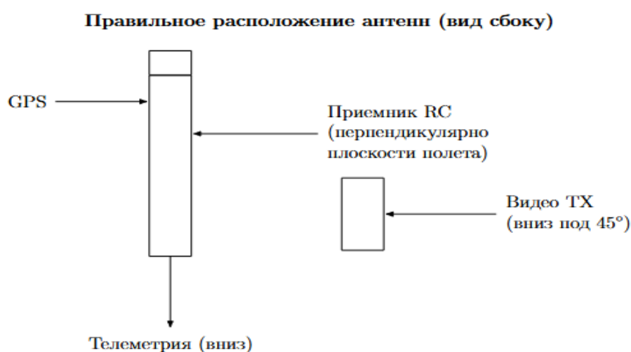
Рис. 18. Типовая схема расположения антенн на БАС
