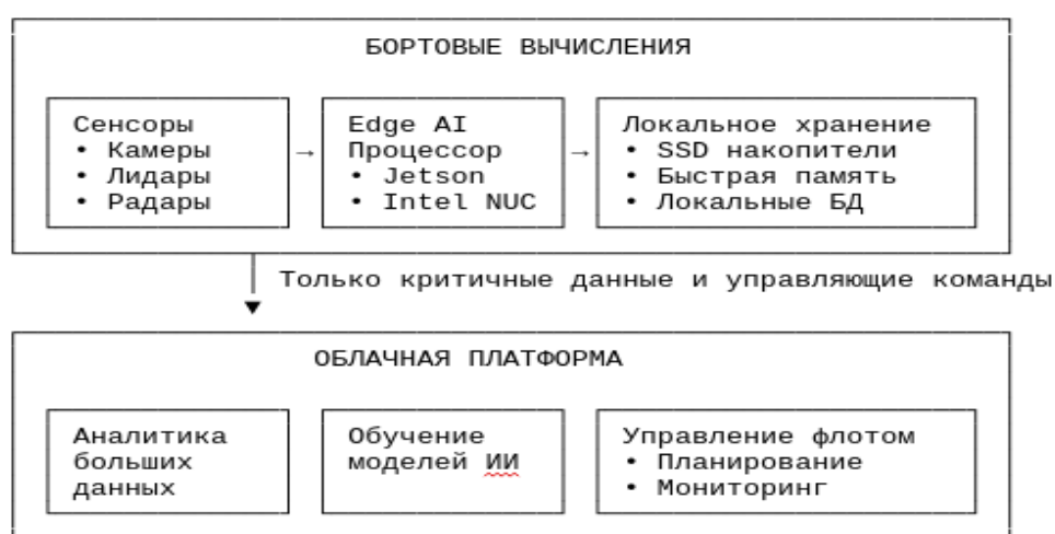
Рис. 96. Архитектура Edge Computing в БАС
