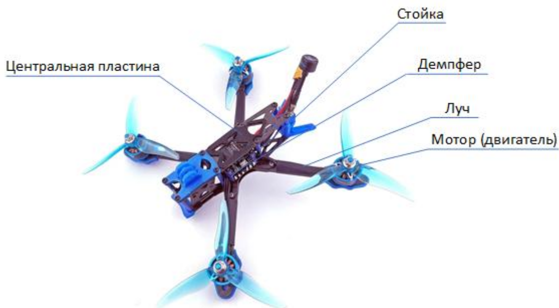
Рис. 3. Основные элементы рамы квадрокоптера
