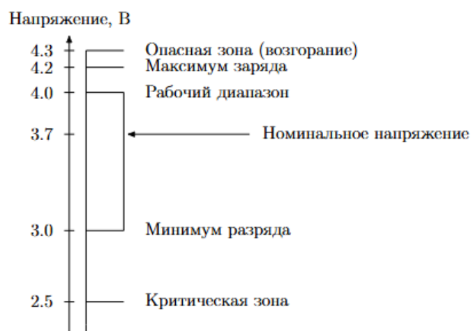
Рис. 42. Характеристические напряжения LiPo элемента:
