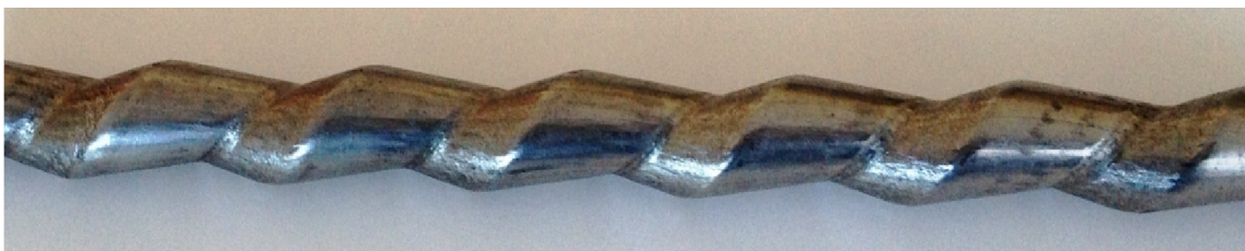
Рис. 6. Теплообменный элемент, полученный методом ротационного обжатия
