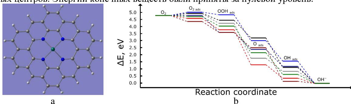
Рисунок 1 – Структура модельного катализатора. Серые сферы – углерод, синие – азот, белые – водород, зелёный – исследуемый металл (а); Энергетический профиль ORR на модельных катализаторах: CoN 4 -серый; CuN 4 -черный; NiN 4 -синий; MnN 4 -красный; ZnN 4 -темно-красный; Cr(OH)N 4 -зеленый. Идеальный катализатор - темно-синий (b).
