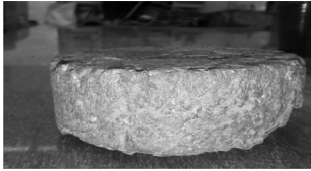
Рисунок 1. Слиток синтезированного СВС-чугаля
