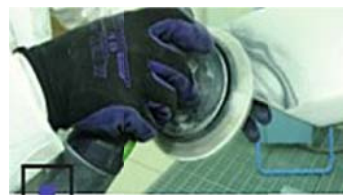
Рисунок 2. Шлифование (чистка) поверхности (P80 – до металла, P180 – понижения риски в зоне перехода)
