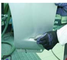
Рисунок 7. Обработка кромок и труднодоступных мест абразивом Р500
