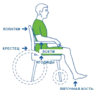
Рис. 1. Схема установки дополнительных датчиков на крестец и под локти
