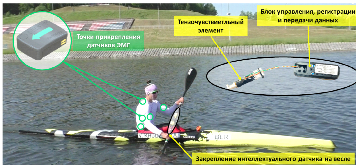
Рис. 1. Фрагмент тестирования с использованием интеллектуального датчика на весло и АПК электромиографии «Delsys Trigno Avanti»
