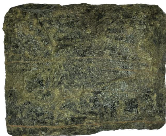
Смоляной камень – пехштейн. Разновидность гидратированного кислого вулканического стекла с признаками структуры течения
