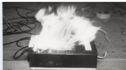
Рис. 2. Загорание бытового электрического прибора от индуктивного элемента расположенного внутри конструкции
