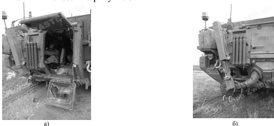
Рис. 3. Кормовая часть машины РХБ разведки «Био Фокс» с открытым задним люком (а) и при отборе пробы почвы вручную (б)
