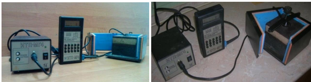
Рис. 1. Электронный измеритель теплопроводности ИТП-МГ-4
