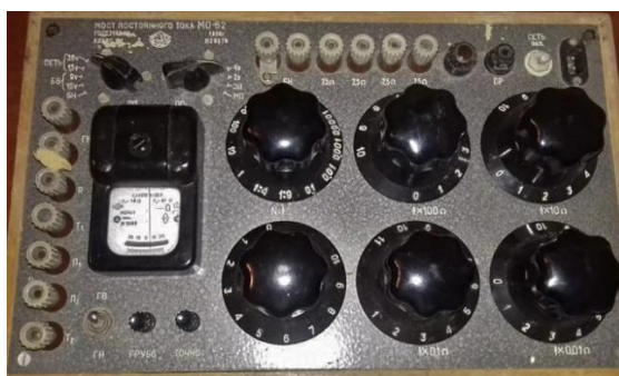
Рис. 2. Мост сопротивлений МО 62.
