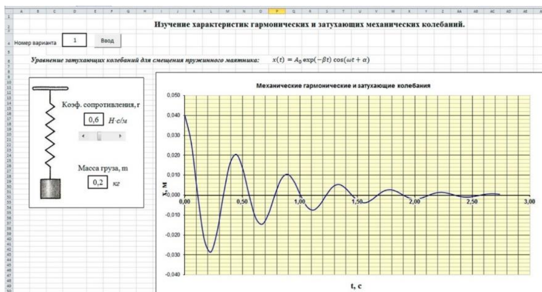
Рис. 5. С помощью полосы прокрутки установлен коэффициент сопротивления 0,6 (Н·с)/м.
