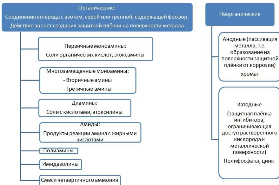
Рис. 4.1. Классификация ингибиторов коррозии по действующему веществу
