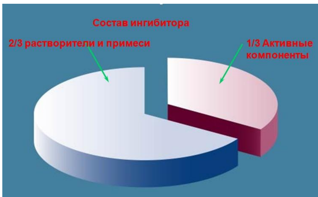
Рис. 6.1. Соотношение растворителя и активной основы в составе ингибитора коррозии
