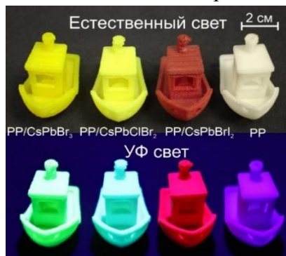
Рис. 1. Фотография моделей, изготовленных методом 3D-печати из полученной полимерной нити (филамента) с включенными перовскитными квантовыми точками
