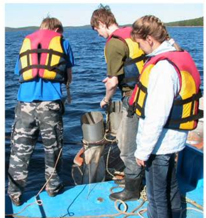
Постановка буксируемой сети Бонго с катера для горизонтального облова зоопланктона
