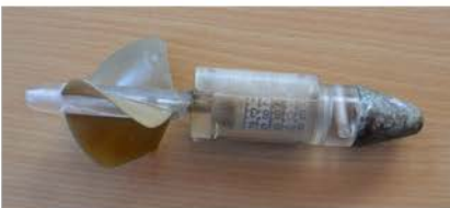
Счетчик потока воды для установки в цилиндрах сети Бонго
