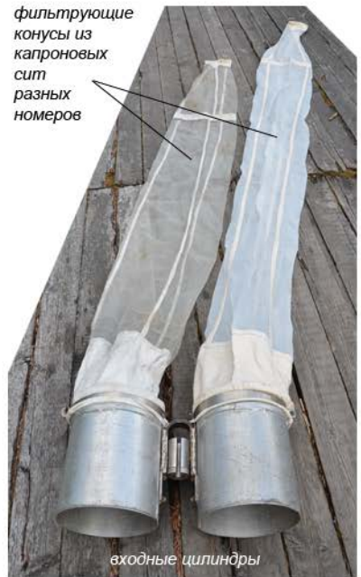
Сеть Бонго для горизонтального облова мезопланктона с фильтрующими конусами с разными размерами ячеей
