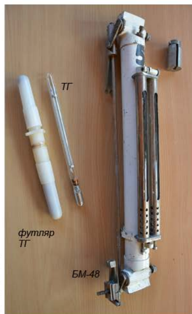
Глубоководный опрокидывающийся батометр БМ-48, глубоководный термометр ТГ и посыльный грузик (справа вверху)
