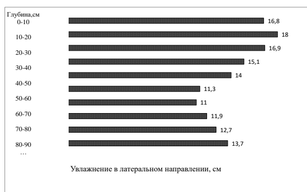
Рис. 1. Динамика увлажнения по слоям светло-каштановой легкосуглинистой почвы латеральном направлении от залитой водой траншеи в течение 30 минут
