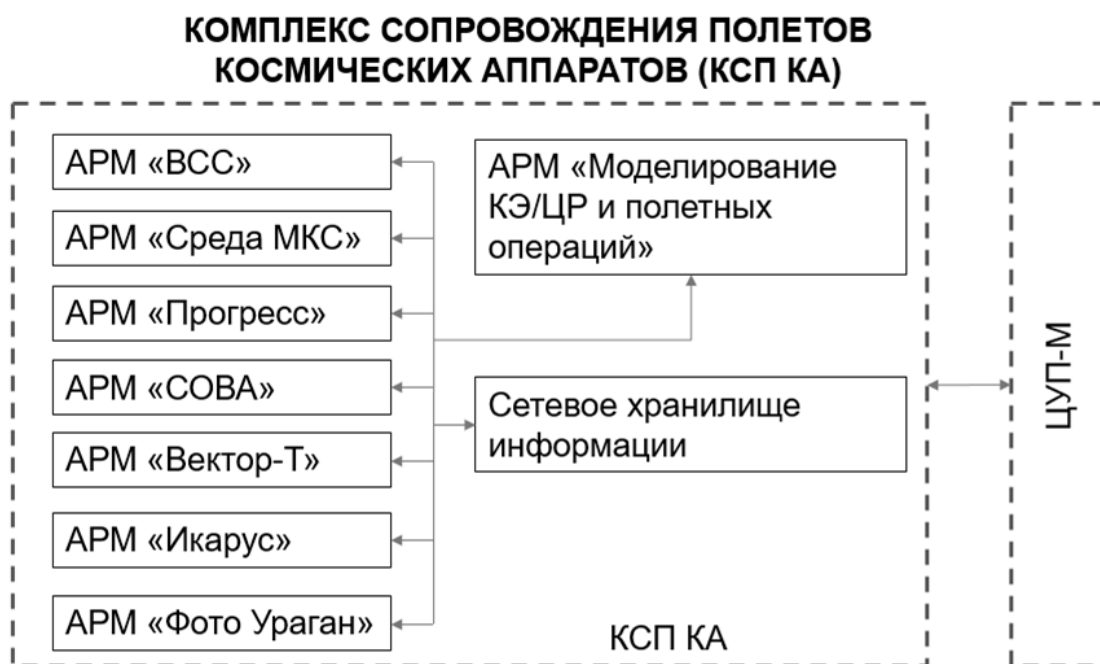
Рисунок 1 - Схема наземного комплекса сопровождения полётов космических аппаратов
