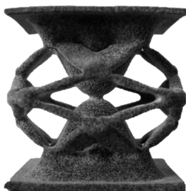
Рисунок 6 - Пример топологической оптимизации
