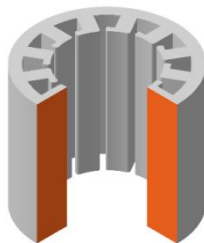
Рисунок 4 – Демпфирующая опора скольжения
