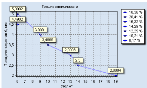
Рисунок 3- Зависимость толщины покрытия \Delta от угла рассеивания расплавленных частиц \alpha [1,5, 7]
