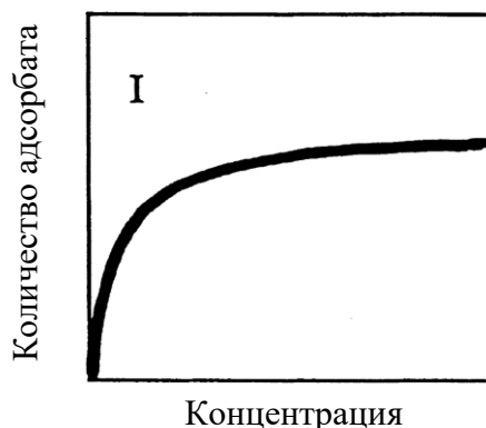
Рис. 20. Изотерма мономолекулярной адсорбции Ленгмюра
