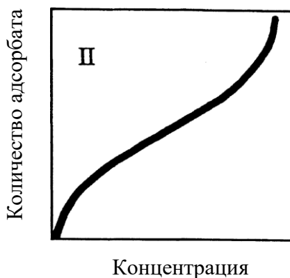
Рис. 21. S-образная изотерма адсорбции.
