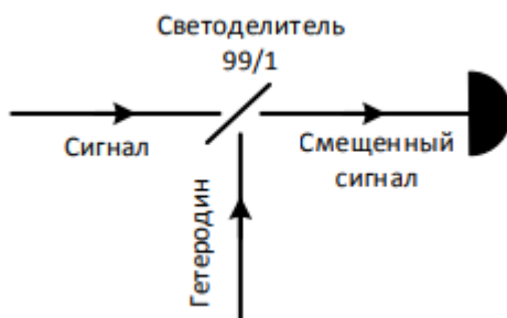
Рис. 1. Теоретическая схема приемника Кеннеди.
