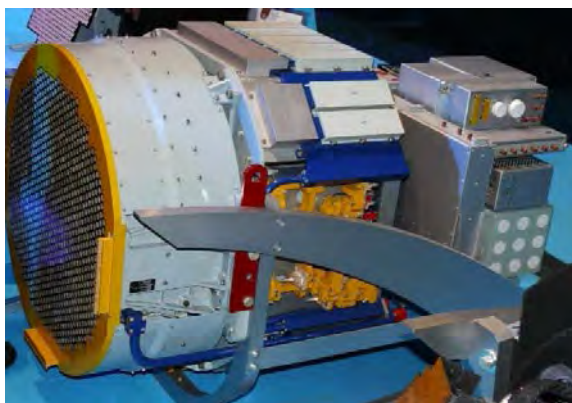
Рис. 1. АФАР система с блоком СВЧ усилителя
