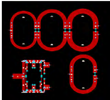
Рис. 3. Иллюстрация трех делителей мощности
