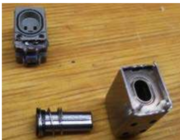
Рис. 3. Катушка и сердечник клапана пневмораспределителя V114A-6H
