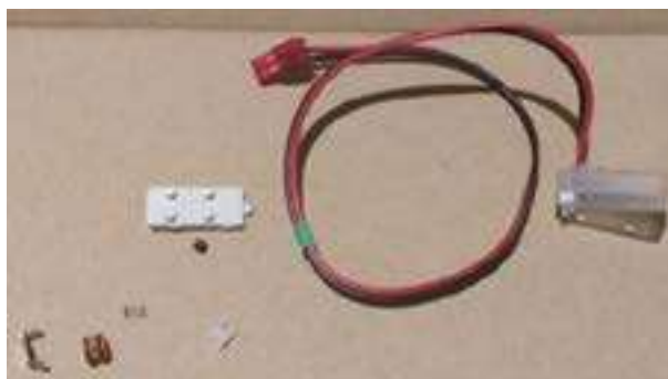
Рис. 2. Разобранный пневмораспределитель V114A-6H
