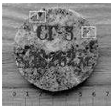
Рис. 1. Образец керна с забоя СГ-3 с областями детальных исследований
