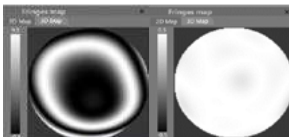
Рис. 3. Волновой фронт до коррекции (слева) и после коррекции (справа) при температуре 95 °С
