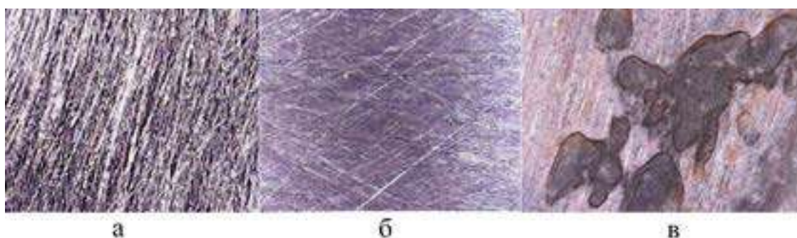
Рис. Микрофотографии исходной стали марки «Ст. 20» (а) и после коррозионных испытания в динамических условиях в модельной пластовой воде с добавлением экстракта ели обыкновенной (б), без добавления ингибитора коррозии (в) при увеличении 200 раз
