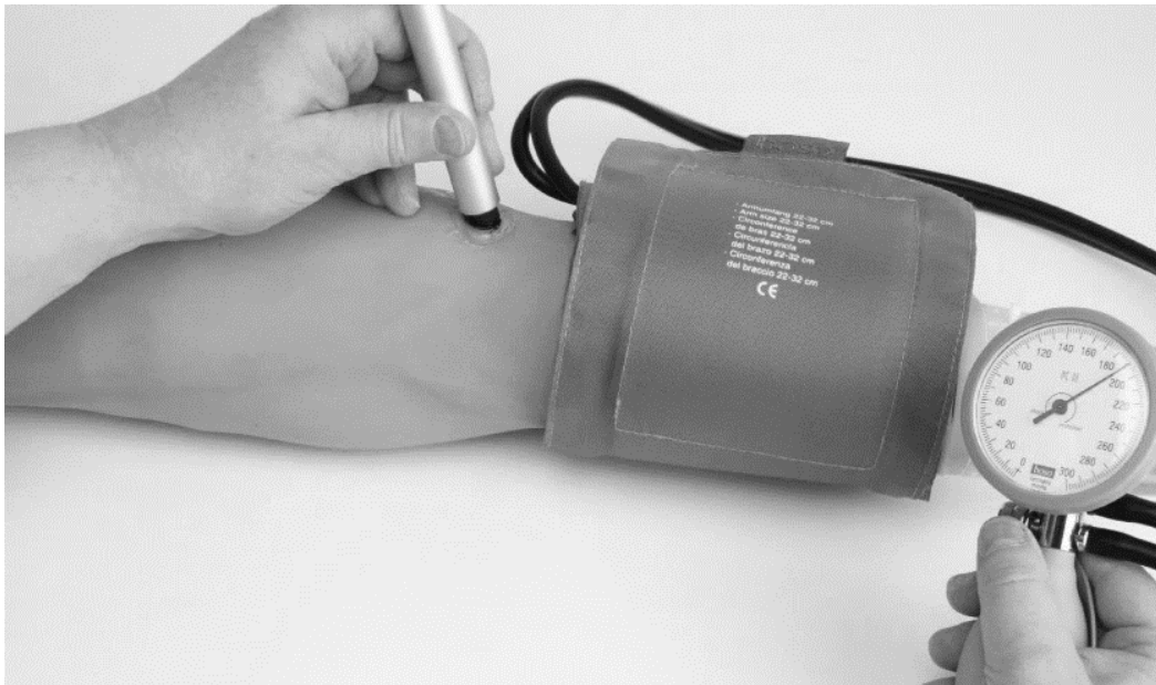
Рис. 48. Размещение манжеты и датчика на фантоме руки
