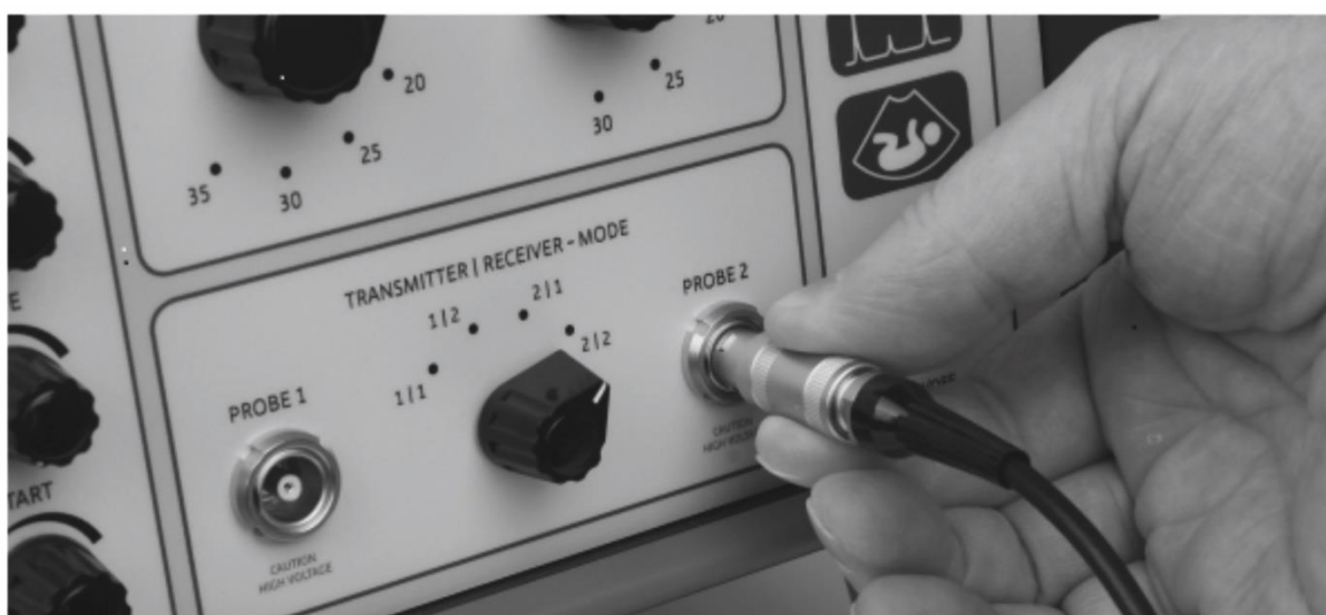
Рис. 13. Порты для подключения датчиков к эхоскопу GS200 и правильный способ подключения коннектора
