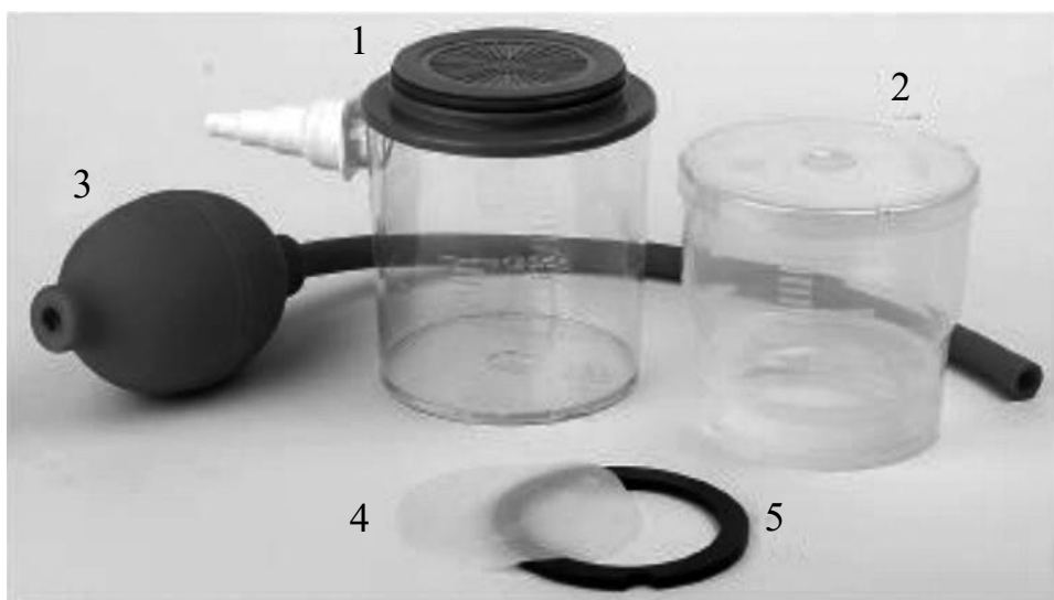
Рис. 36. Модель сердца: (1) нижняя ёмкость с переходником к трубке, (2) верхняя ёмкость с крышкой, во время измерений крышку снимают и верхнюю ёмкость заполняют водой, (3) резиновая груша, (4) мембрана, (5) уплотнительное кольцо
