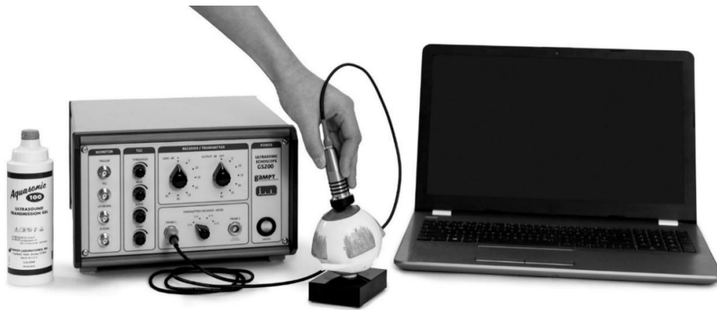
Рис. 27. Измерение времени распространения УЗ в структурах глаза
