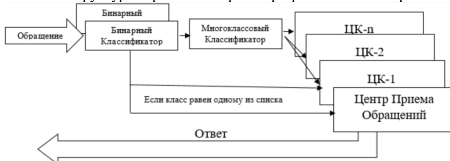
Рис. 3. Структура обработки запроса в модификации разработанного алгоритма.
