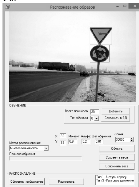
Рисунок 2. – Интерфейс окна обучения и распознавания дорожных знаков с результатами работы.
