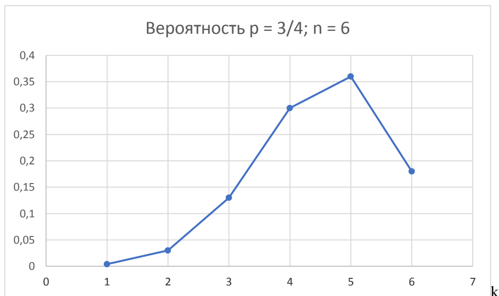
Рис. 1. Вероятности наступления события A (расход будет нормальным) от числа испытаний k (дни) – по формулам (4а).
