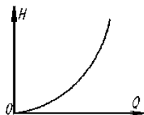
Рис. 4. 2. Характеристическая кривая простого трубопровода при турбулентном режиме
