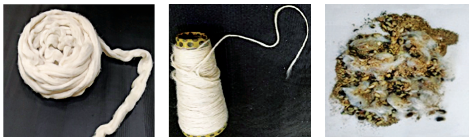
2-nji surat. Alnan önümler: a) darak lentasy, b) apparat ýüplük, ç) önümçilikde ulanyp bolmaýan galyndy
