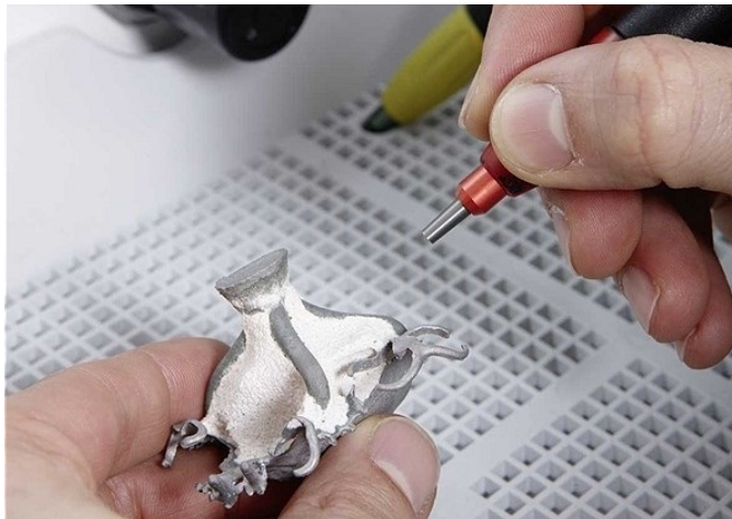
Рис. 28. Пескоструйная обработка каркаса бюгельного протеза
