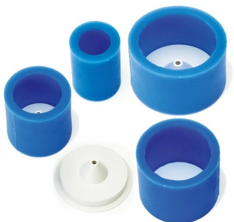
Рис. 24. Силиконовая форма для опоки.
