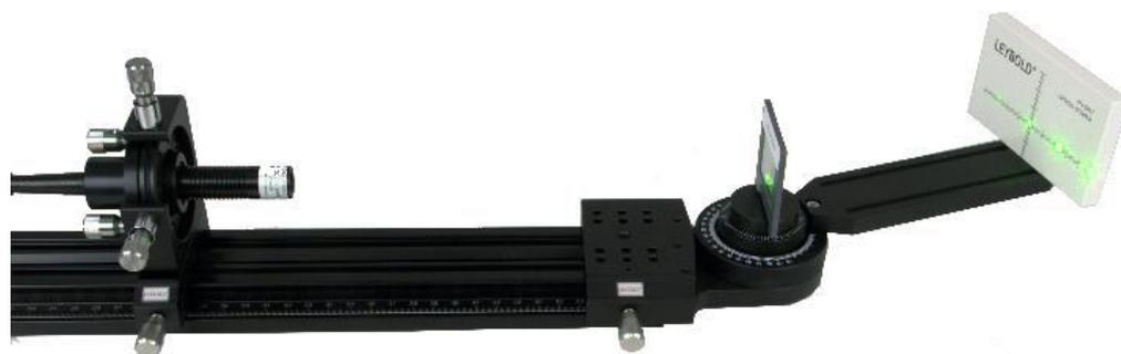
Рис. 6. Установка для измерения углов дифракции
