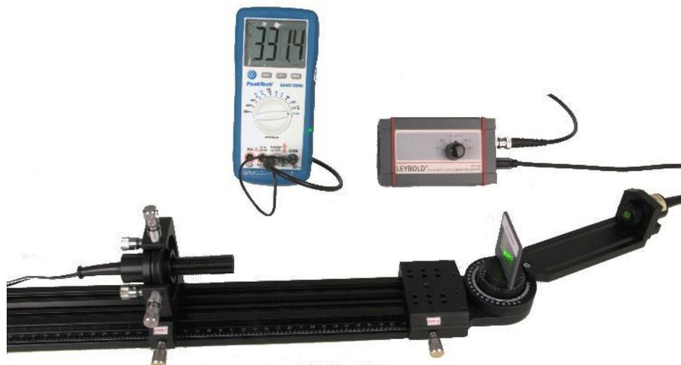
Рис. 7. Установка для измерения интенсивности максимумов дифракции
