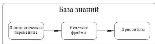
Рисунок 3.1 - База знаний нечеткого регулятора и методы ее заполнения
